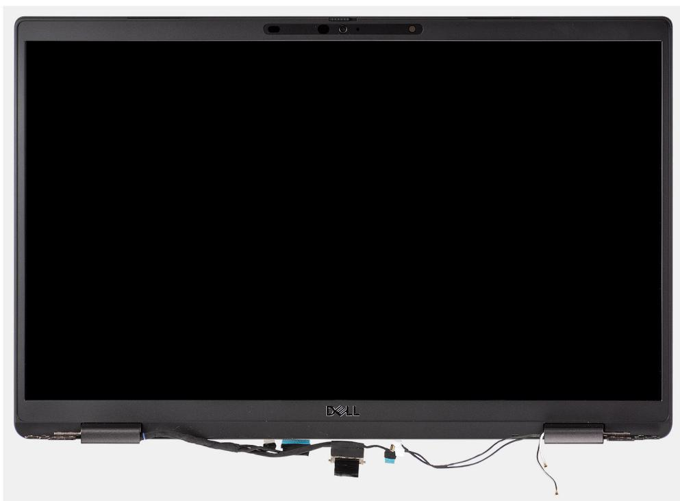
Angka 5. Unit display dengan kabel antena WLAN dan WWAN
