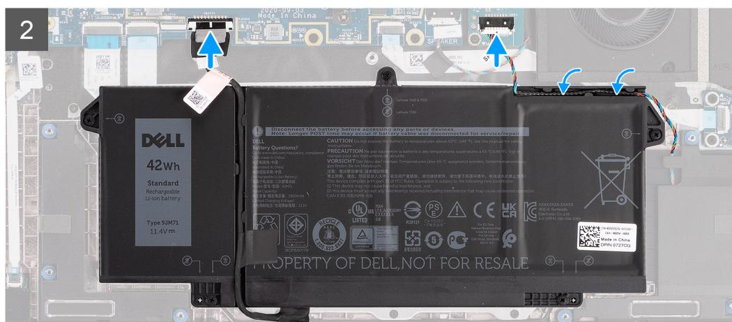
**(i) CATATAN:** Jika baterai dilepaskan sambungannya dari board sistem, terjadi keterlambatan selama boot komputer saat komputer mengalami reset RTC.
