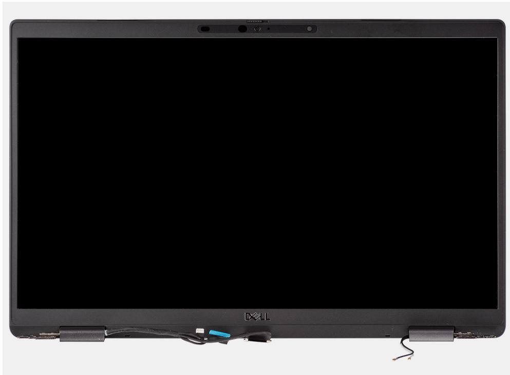
Angka 4. Unit display dengan kabel antena
