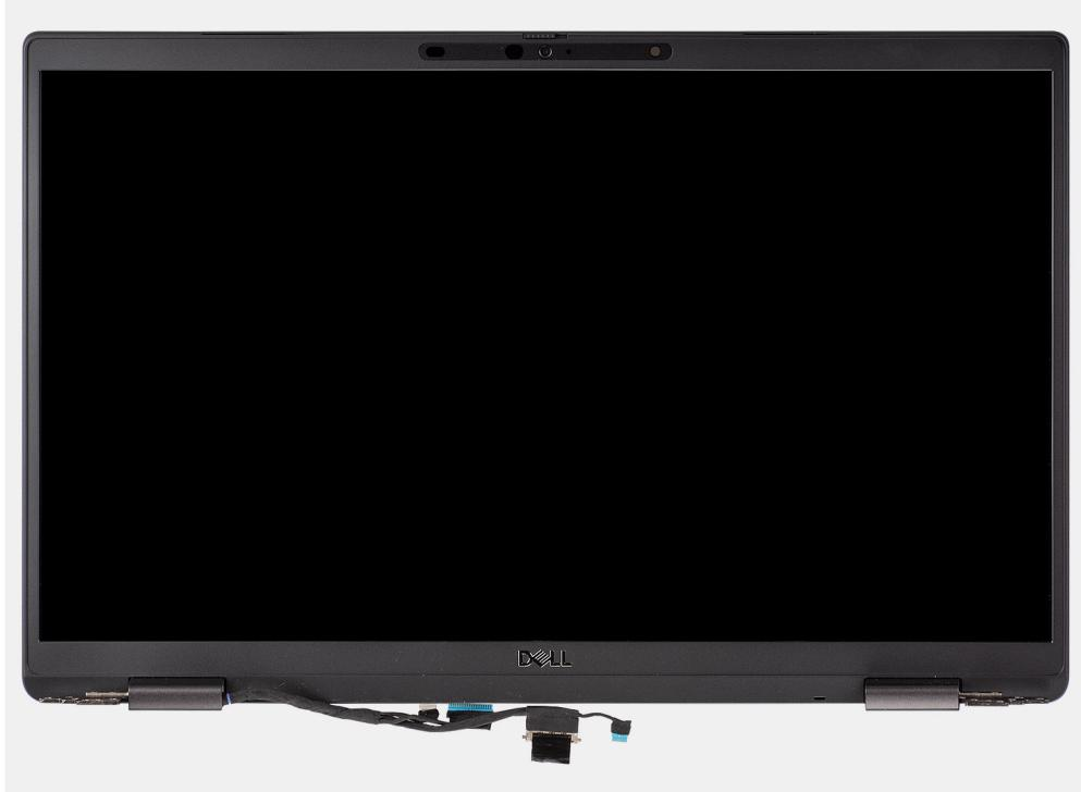
**Angka 1. Unit display tanpa kabel antena**
