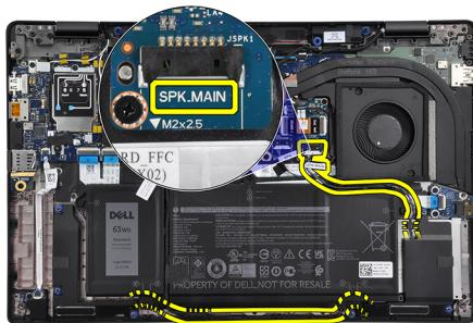
Sambungkan kabel speaker utama ke konektor **SPK.MAIN** pada board speaker dan rutekan kabel speaker melewati kabel speaker tweeter.
